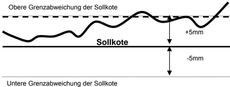
Die absolute Toleranz für Estriche (Norm SIA 251), Untergründe zur Aufnahme von Bodenbelägen ohne Höhenausgleich (z.B. Kunstharzbeläge) und Bodenbeläge beträgt  $\pm 5\text{mm}$ .
