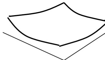
Nach Norm SIA 251 wird die Aufwölbung gemessen, indem eine 1m lange Wasserwaage ausgehend von der Ecke oder vom Rand waagrecht ausgerichtet wird. Der maximale freie Abstand zum Estrich wird als Aufwölbung gemessen.
