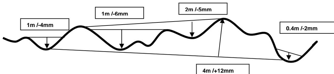
Die Messungen erfolgen mit Hilfe von Messlatten mit Längen von 0.4m, 1m, 2m oder 4m. Die Latten werden auf den Hochpunkten aufgelegt. Damit lassen sich die Abstände zu den Vertiefungen mit Hilfe einer Schiebelehre, eines Messkeiles oder mit Messplättchen ermitteln. Es werden nur **negative** Abweichungen gemessen. An den überstehenden Enden der Messlatten dürfen keine Messungen vorgenommen werden.
