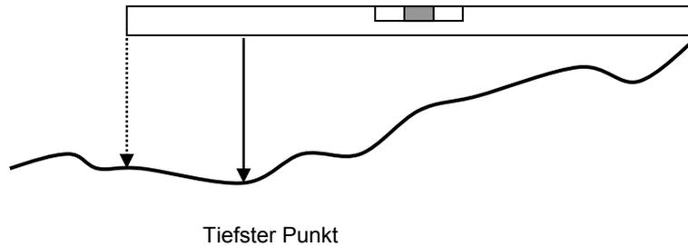
Die Rückverformung wird durch die Fugenöffnung zwischen Fussleiste und Bodenbelag gemessen. Massgebend ist die Distanz zwischen der maximalen und der minimalen Fugenöffnung.
