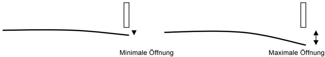
Die Messung erfolgt mit Messkeilen oder Plättchen auf 1mm genau. Die Rückverformungen dürfen maximal 7 mm betragen.
